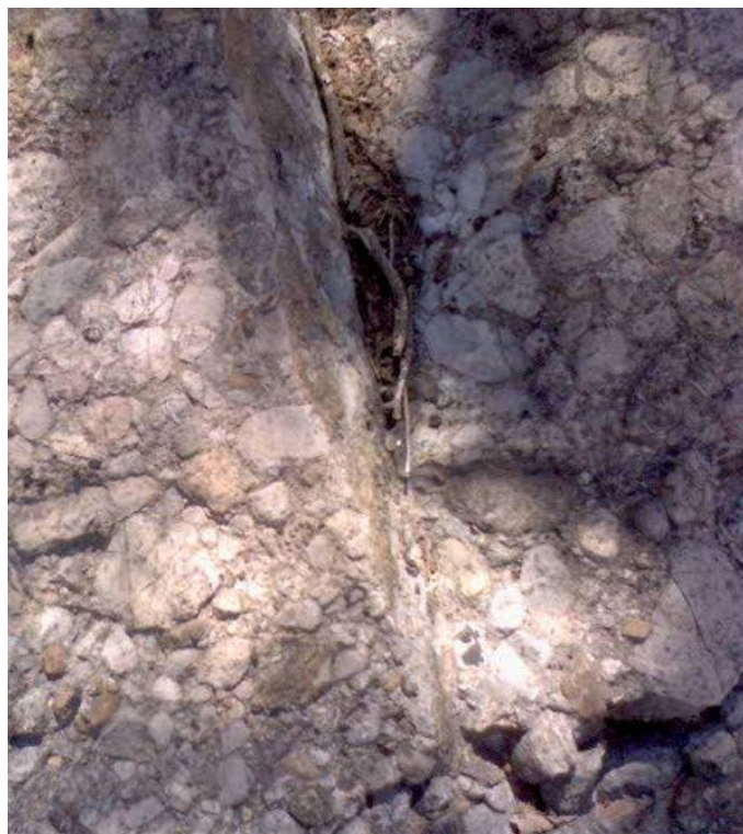
Figura 3. Conglomerado Balsas muy endurecido y compuesto por fragmentos de caliza.
